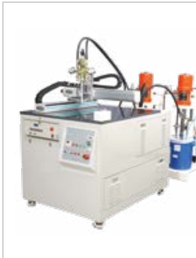
▲ 이액 실리콘 도포 & X-Y-Z Robot
